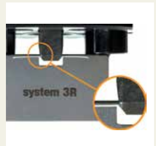
Die Lippe der Palette ist so gewinkelt, dass sie dem Winkel des Gegenstücks entspricht. Das maximiert die Passfläche zwischen den Teilen, was die Ausrichtungspräzision optimiert, den Verschleiß minimiert und so für dauerhafte Präzision sorgt.
