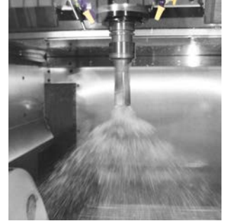
Refrigeración a través del cabezal
