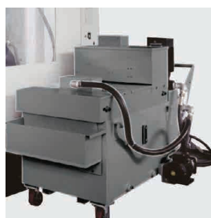
Jednotka pásového filtru na nádrži chladicí vody
