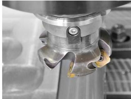
Protección de la máquina y del cabezal (MSP)
