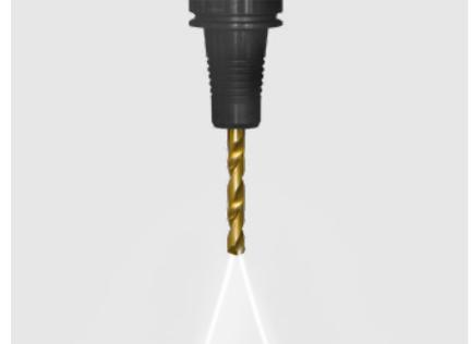
Refrigeración a través del cabezal
