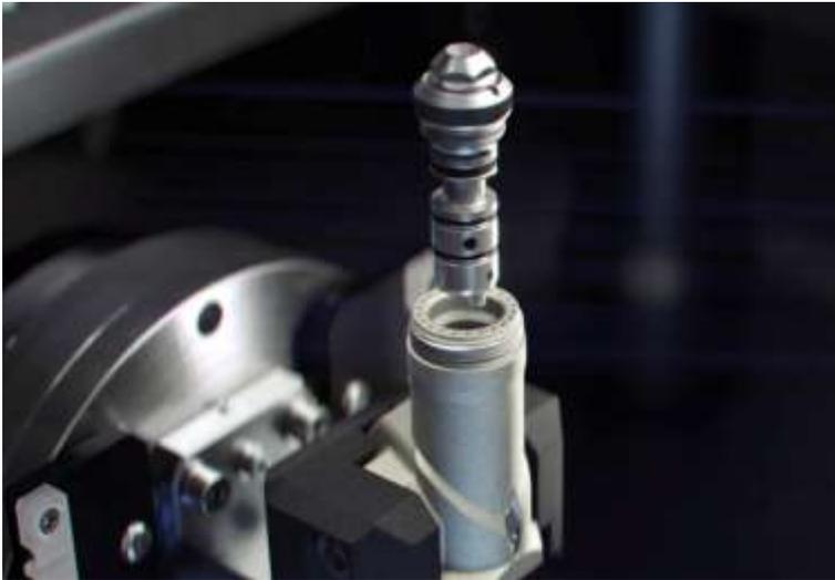
GF Machining Solutions ofrece al usuario, por primera vez, la posibilidad de trabajar con guías abiertas o cerradas gracias al sistema rápido y sencillo de cartuchos intercambiable de la gama CUT X.
